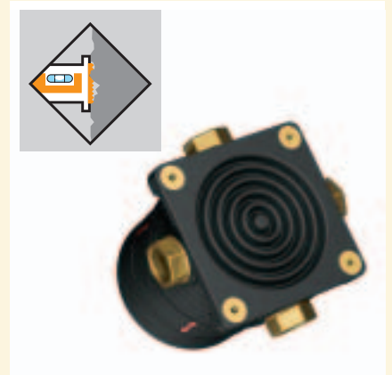
Prstencové centrálne zvlnenie základovej časti Flexx.Boxx vyrovnáva nerovnosti steny.
